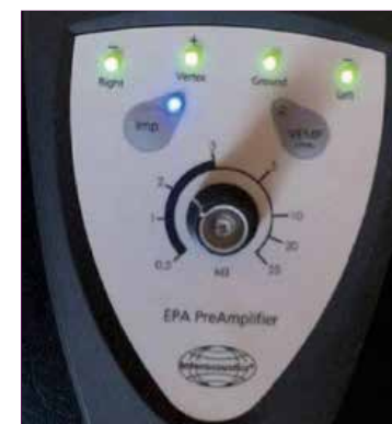
Figura 7.4. En nuestro equipo, el registro de las correctas impedancias se muestra con una luz verde en cada uno de los electrodos. Si no fuese correcta, deberíamos revisar el electrodo y la preparación de la piel del paciente.
