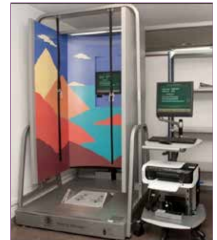
Figura 14.1. Posturógrafo en el que podemos ver la plataforma de presión (1), monitor para la representación del centro de presiones y los objetivos de desplazamiento (2), pantalla móvil generadora de conflicto visual (3) y ordenador con software de análisis.
